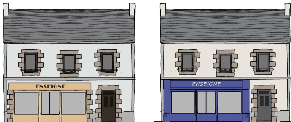
EXEMPLES D'UN COMMERCE QUI OCCUPE 2/3 DU REZ-DE-CHAUSSÉE
