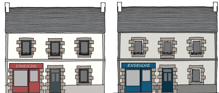
EXEMPLES D'UN COMMERCE QUI OCCUPE 1/3 DU REZ-DE-CHAUSSÉE
